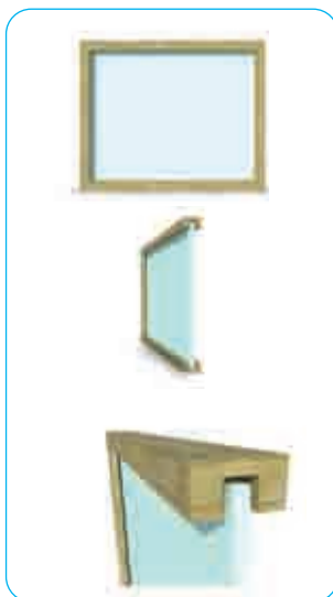
Gambar 3.17 Dudukan jendela dibuat lebar, untukantisipasi pemuaian luas.
