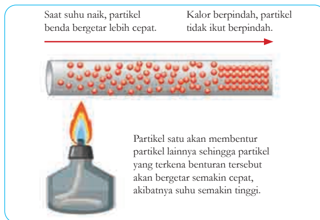
Gambar 3.9 Perpindahan kalor secara konduksi pada logam.
