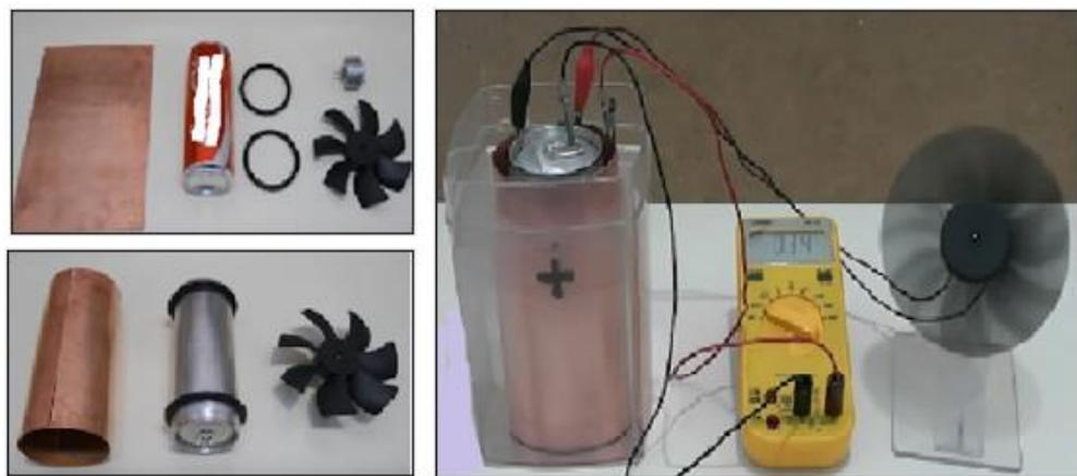
Gambar 6. Uji terbatas sel Volta dari garam dapur
