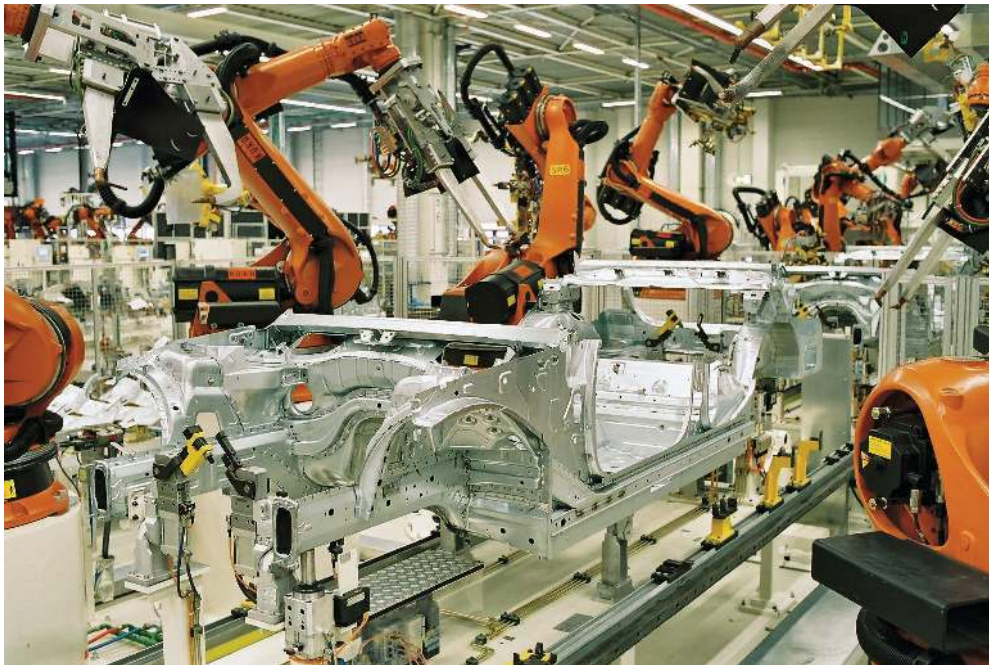
Gambar 4.13 Teknologi otomatis perakitan mobil di Jerman
