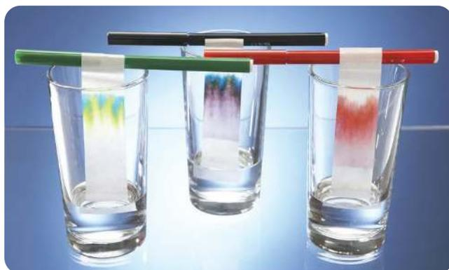
**Gambar 5.30** Contoh hasil kromatografi pada tinta warna warna
