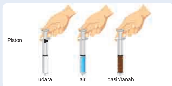
Gambar 2.3 Percobaan menguji sifat kompresibilitas zat padat, cair dan gas.
