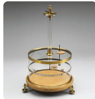
**Gambar 4.3** Eksperimen percobaan Coulomb untuk menentukan muatan listrik.
